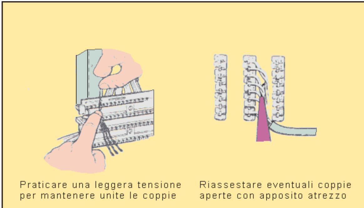
Figura 4 - Come evitare la separazione delle coppie
